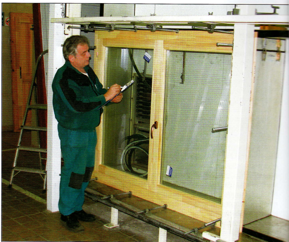
1. kép – Középen felnyíló fa ablak a vizsgáló berendezésen
