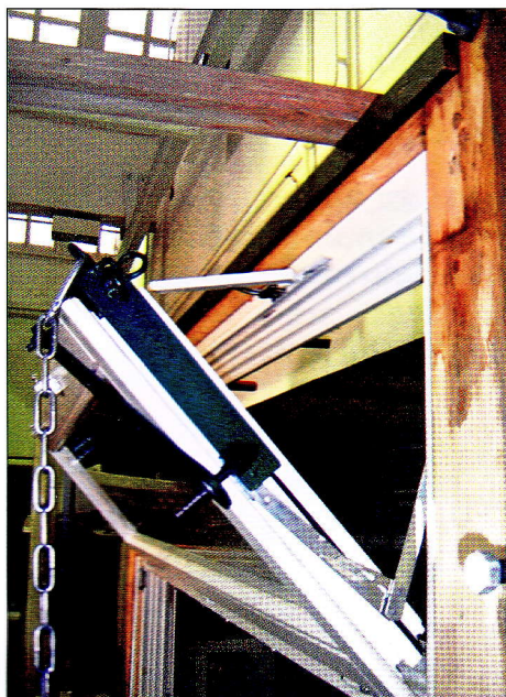
2. kép Bukószárnyat rögzítő ollókar terhelése a távnyitó kiiktatása után. A terhelés sémája a szabványban.
