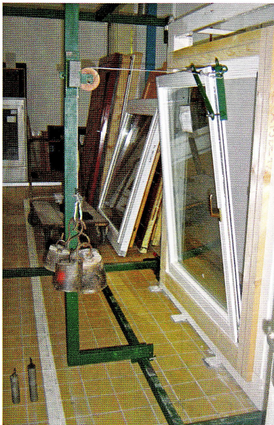
3. kép: a szárny erőltetett bukztatásának, feszültsénekek próbája 350 N terhelésnél
