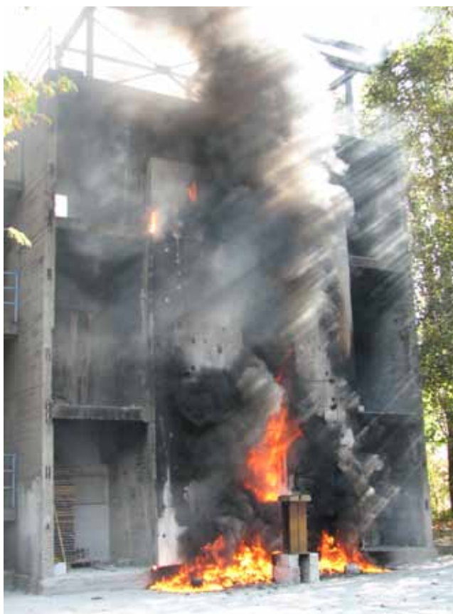
A nem megfelelően kialakított homlokzati hőszigetelő rendszerek komoly tűzvédelmi kockázatot jelentenek. A kép a rendszer homlokzati tűzterjedés vizsgálatának 44. percében készült.
