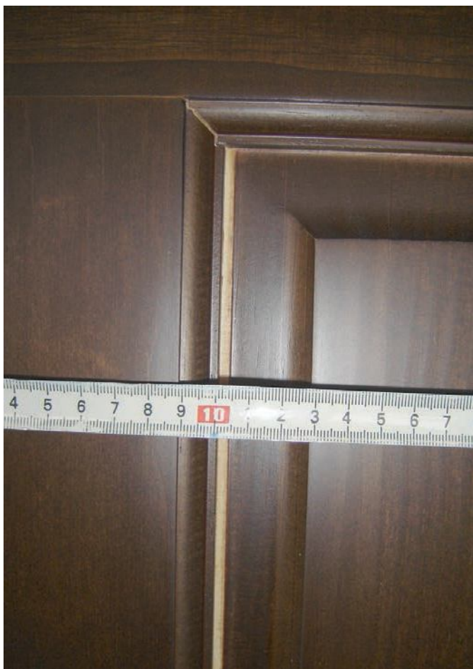
1. kép: Nedves alapanyagból gyártott belsőteri ajtó betétjének méretváltozása a használatba vétel után
