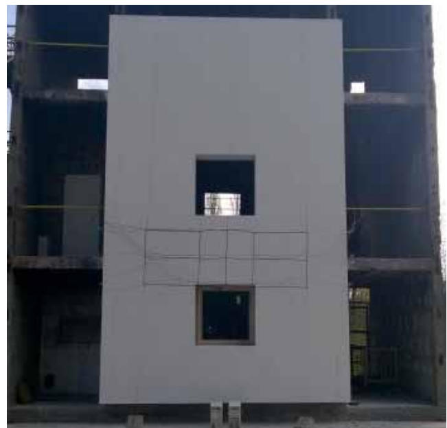
MSZ 14800-6:2009 SZABVÁNY SZERINTI HOMLOKZATI TŰZTERJEDÉSI VIZSGÁLAT VALÓS MÉRETŰ, VIZSGÁLATRA KÉSZ MODELLE
