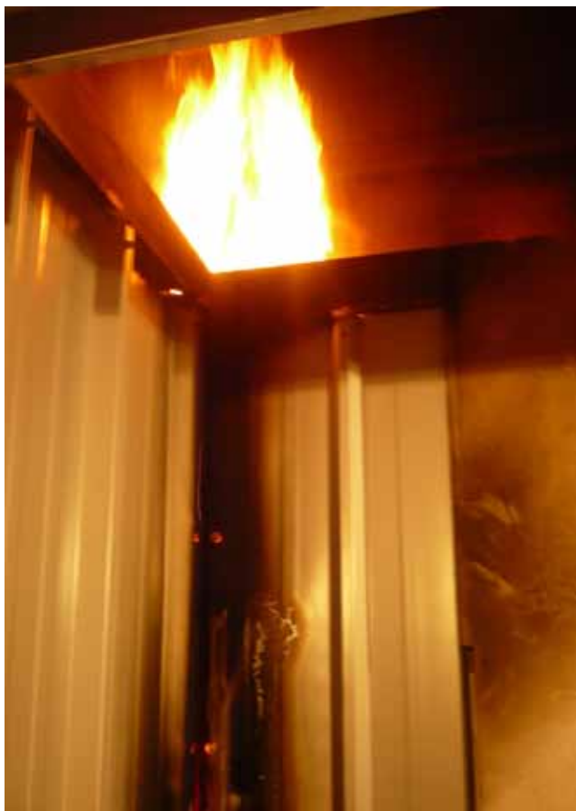
C-s3,d0 PUR SZENDVICSPANEL VÉGE A VIZSGÁLATNAK A HŐSZIGETELŐ MAG ÖNÁLLÓAN ÉG
