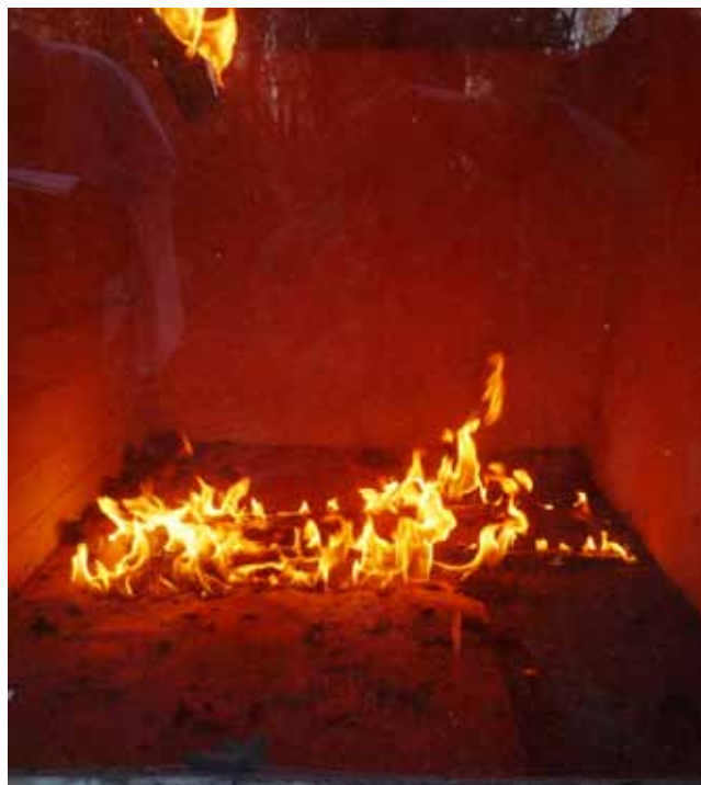
FURNÍROZOTT FAFORGÁCS MENNYEZET BURKOLAT, HŐRE LÁGYULÓ RAGASZTÓVAL RÖGZÍTVE (G2)
