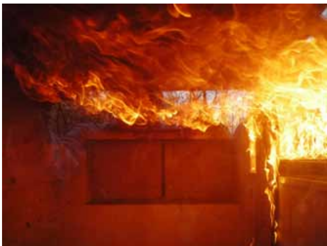
MENNYEZETBURKOLAT GYÚJTÁSVESZÉLYESSÉG VIZSGÁLAT
