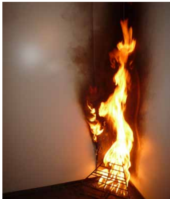
SZENDVICSPANEL VIZSGÁLATA – BELÜL ÉG A HŐSZIGETELŐ HAB
